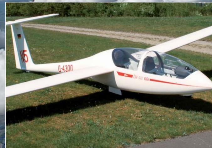
**Foto oben:** Zweisitzer DG 505 Elan, Leistungsflugzeug für den Streckenflug, Höchstgeschwindigkeit 270 km/h.
